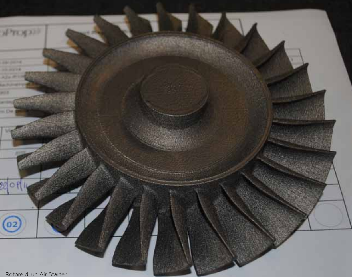
Rotore di un Air Starter prodotto con tecnologia additiva (GE Avio)
